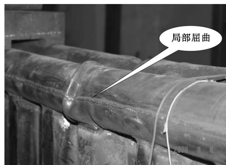
图 11 试验梁 A 破坏模式 Fig 11 Failure mode of Beam A
