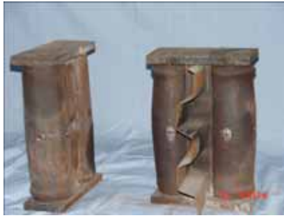
图5 轴压短柱试件 A1、试件 C1 试验照片
