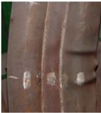
图5 试件 B-1 破坏时中截面附近区域的照片
