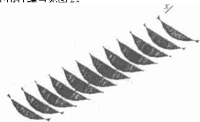
图 6 吊杆横梁均布荷载面内弯矩
