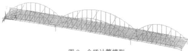
图3 全桥计算模型
